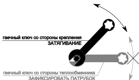
Рис. 5. Подключение к системе подачи теплоносителя
